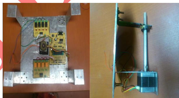
Fig 5.a) Controller Setup b) Sprinkler Setup
